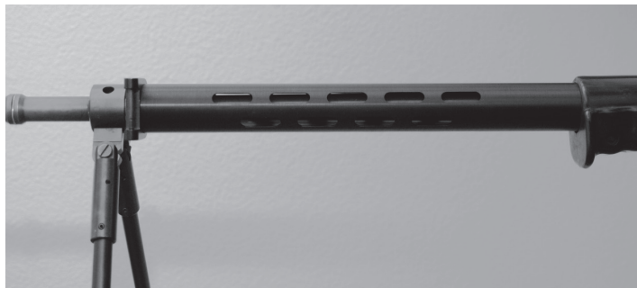
Bild 20: Mantelrohr zu Stgw 57
