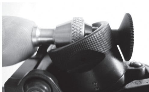
Figura 5: Sistema di filtri colorati Wyss innestabile
